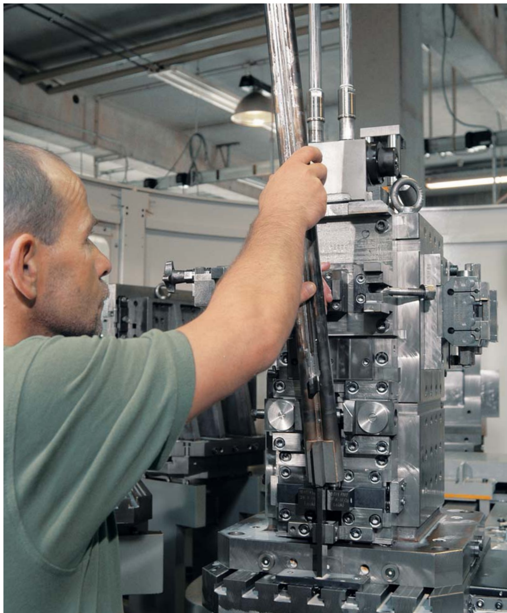
Hantverk möter high-tech: handlörd pipa spänns fast i CNC-fräsmaskinen.
