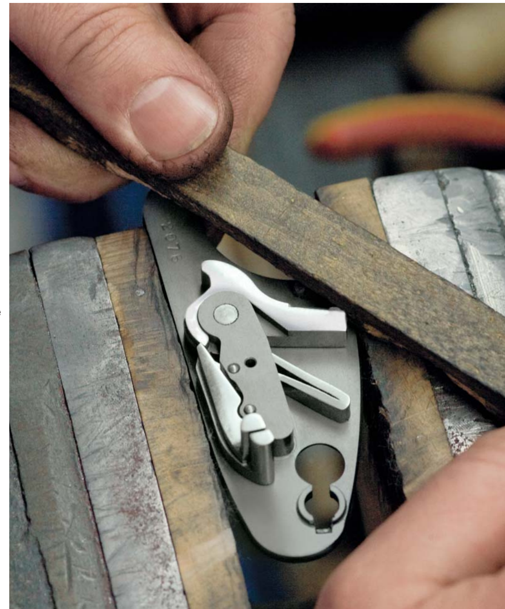
"Svartmontören" spänner sidålåsets bugfjäder.
