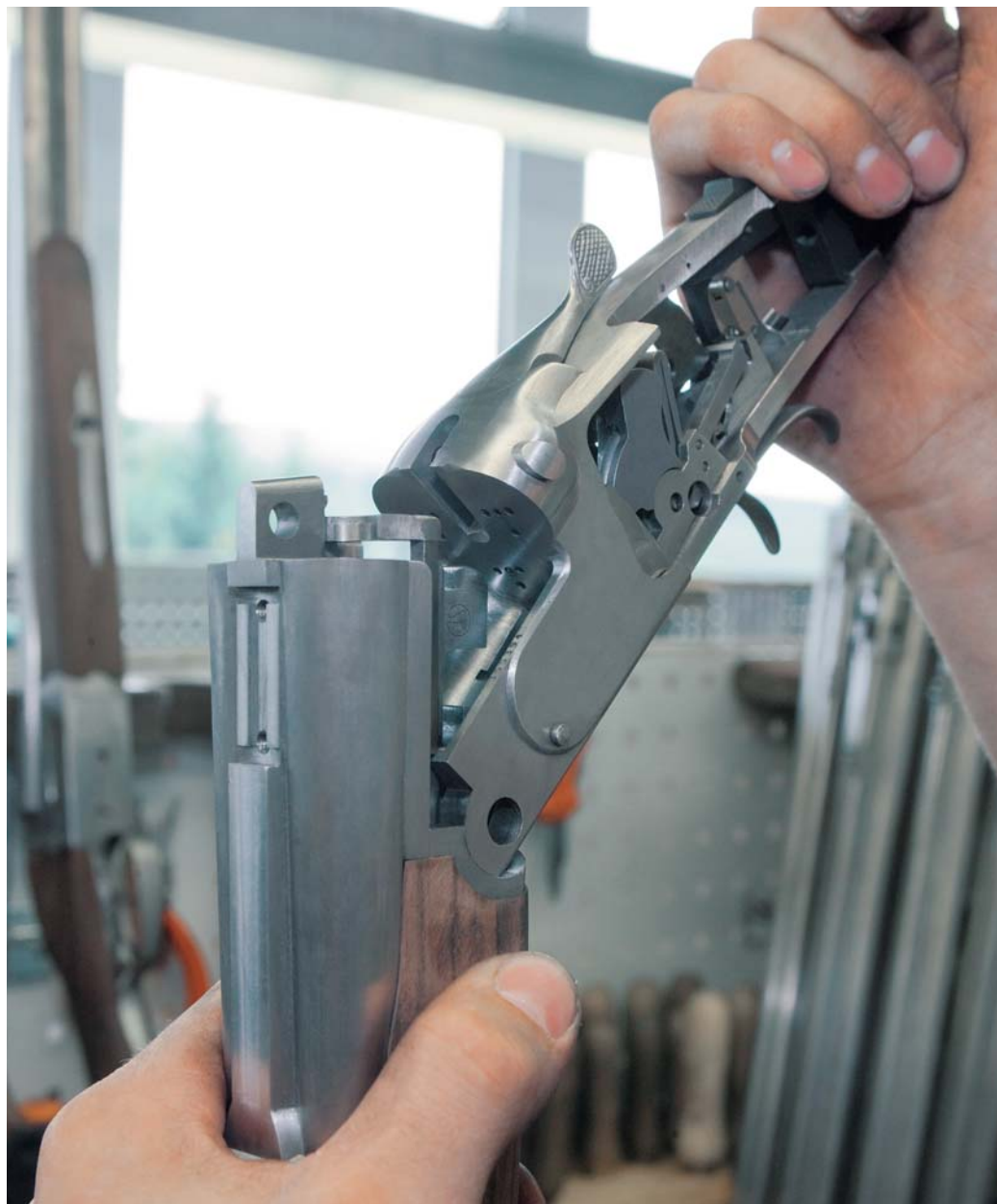
Det ska sitta perfekt: toleransfritt ihopfogat drillingsystem.
