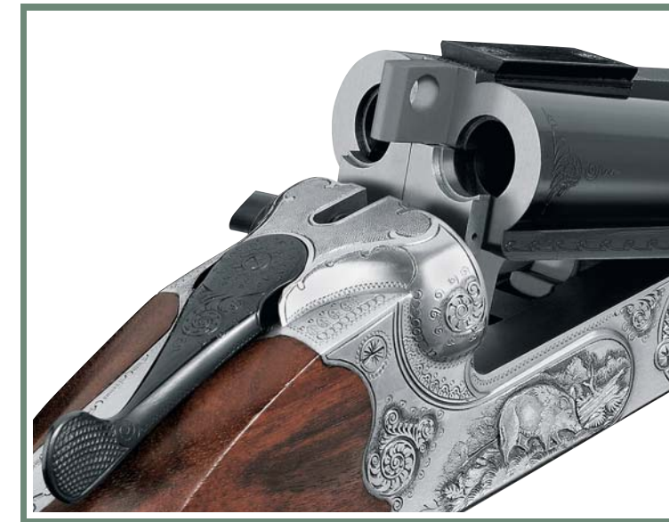
Låsmekanism enligt Greener med dubbla pipklackar.
